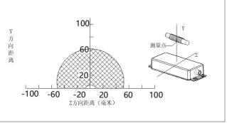
检测范围会根据 RF 标签卡、环境温度、周围金属、干扰环境等影响发生改变,检测范围图仅供参考,安装时请充分确认。
