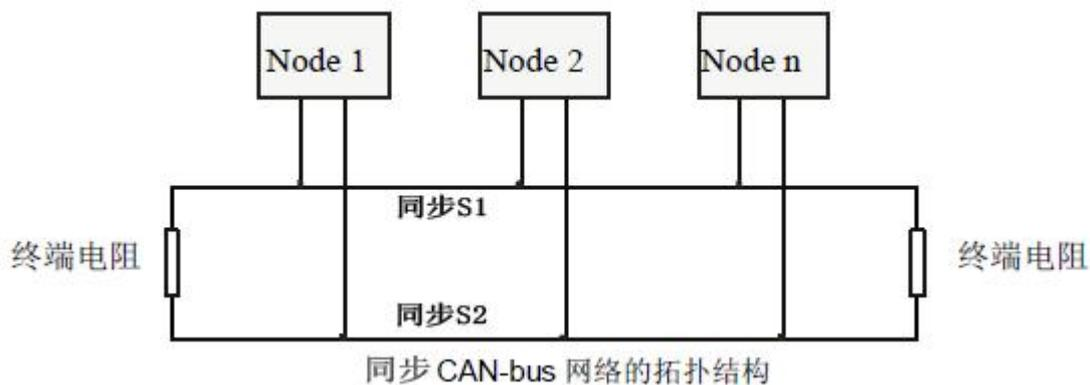
注意：同步（CAN-bus）总线电缆建议使用屏蔽双绞线。若通讯距离超过 1Km，应保证线的截面积大于Φ1.0 平方毫米，具体规格应根据距离而定，常规是随距离的加长而适当加大。
